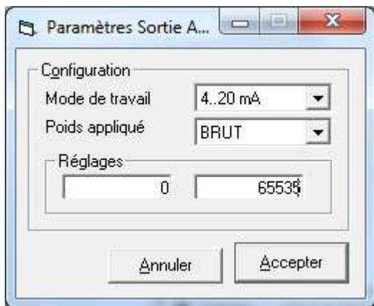
Il est recommandé de définir les paramètres de réglage (**Réglages**) directement sur l'indicateur. En effet, à chaque modification sur le formulaire de l'application, il faudra renvoyer les paramètres à l'indicateur, ce qui est peu pratique.
