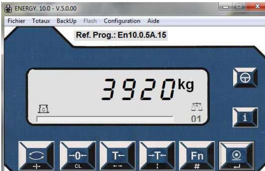
Au démarrage le programme affiche dans la fenêtre principale l'indicateur **ENERGY**. La communication peut alors s'effectuer en **RS-232/RSS-422** ou en **ETHERNET**. Pour choisir le type de communication à utiliser, entrer dans le **Menu: Configuration \ Communication**.
