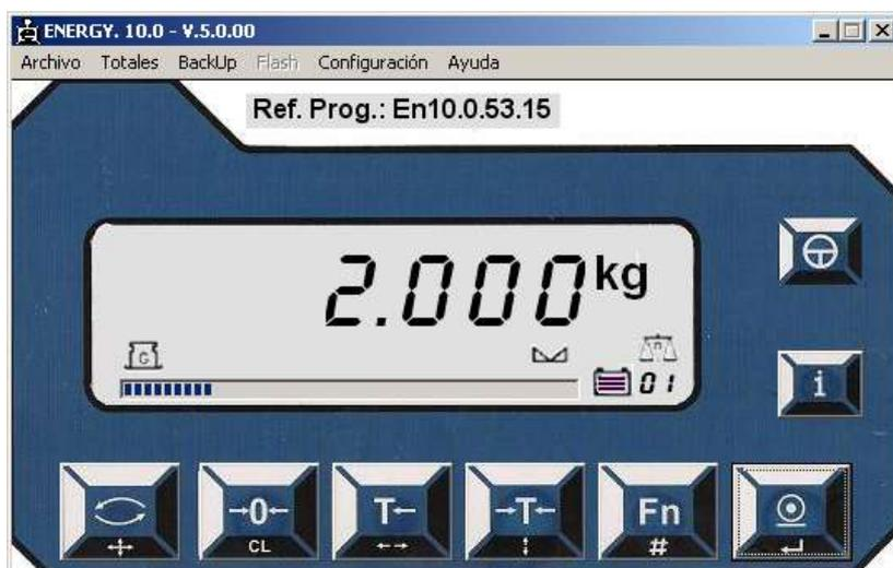
Al arrancar la aplicación mostrará la ventana para visualizar el equipo **ENERGY/ORION**. La comunicación con el equipo puede ser vía **RS-232/RSS-422** o vía **ETHERNET**. Para programar el tipo de comunicación entrar en el **Menú:**
