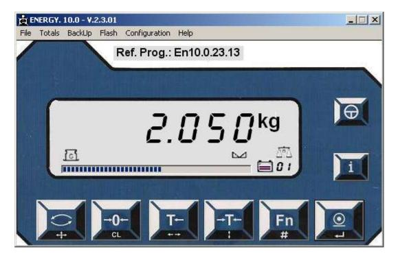
Al arrancar la aplicación mostrará la ventana para visualizar el equipo *ENERGY*. La comunicación con el equipo puede ser vía *RS-232/RSS-422* o vía *ETHERNET* Para programar el tipo de comunicación entrar en el *Menú*:
