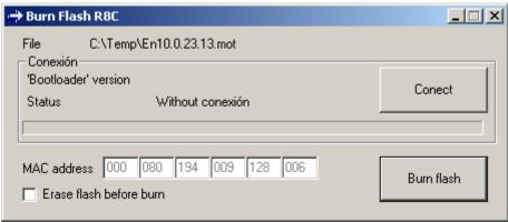
Para volver a intentar la conexión no es necesario salir de la ventana actual. Pulsar el *pulsador RESET* del cable y reintentar la conexión pulsando el botón *Conectar*.
