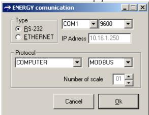
Se deberá seleccionar el canal de comunicación del ordenador al que está conectado al equipo. Y la velocidad en baudios de la conexión. La velocidad debe ser la misma que la configurada en el equipo. El resto de parámetros de comunicación deben ser: *Paridad: NO, 8 bits de datos y 1 bit de STOP.*
