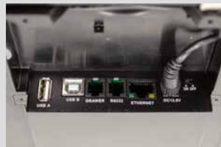
Conexiones: USB-A, USB-B, cajón monedero (DRAWER), RS232, Ethernet, Alimentación, ON/OFF
