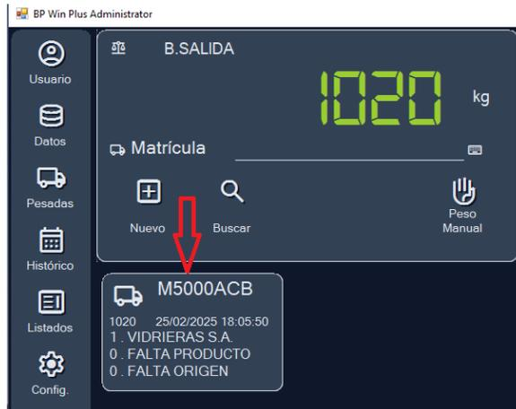
Para darle salida, cuando regrese, se puede pulsar directamente sobre ítem del camión y se abrirá el formulario para la introducción de datos de la **Segunda Pesada**.
